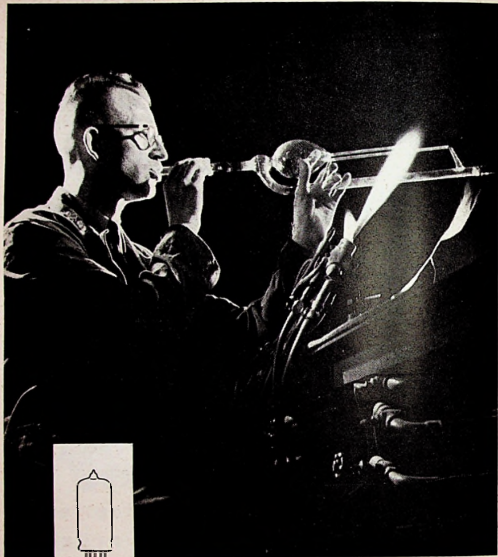
Het blazen van een glasballon voor een prototype.
